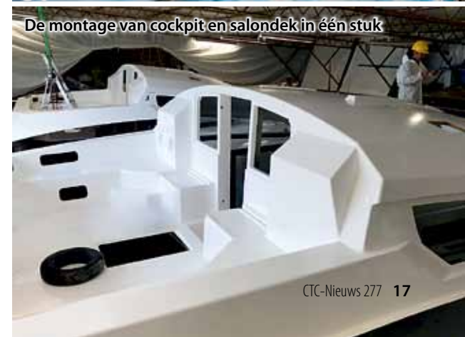
Alle laminaten worden d.m.v. vacuüminfusie geproduceerd: schoon en duurzaam
